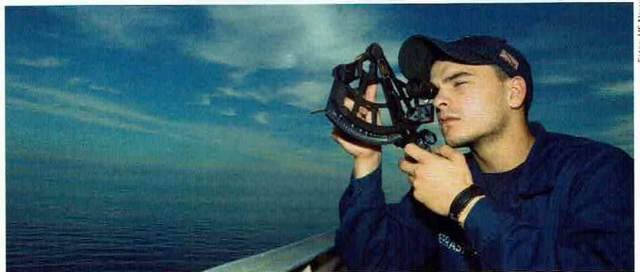
Ein Matrose des Zerstörers USS RAMAGE misst per Sextant die Entfernung zu einem anderen Schiff
